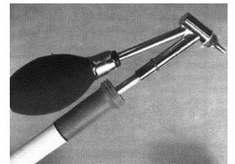
\***Desoldador**. Los modelos más económicos tienen una perilla de goma para aspiración manual del estaño previamente fundido a través de su correspondiente boquilla. Esta boquilla es intercambiable y existen modelos de diferentes diámetros. Existen desoldadores que tienen bombas de vacío electromecánicas incorporadas que facilitan esta operación.
